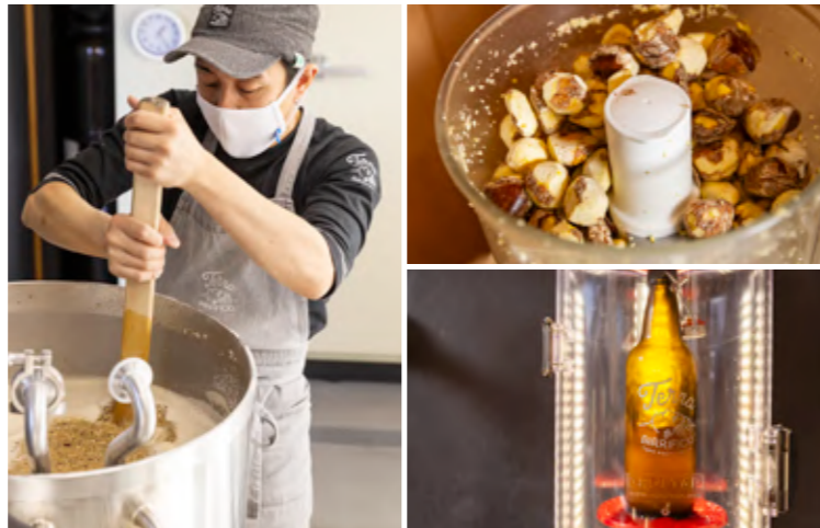
1 麦汁生成は手作業で行う。まさにクラフト! 2 マローネには上越市三和区の栗を贅沢に使用 3 量り売り専用の充填機。容器内の空気を炭酸ガスで出してから生ビールを充填することで香りの劣化を防ぐ
