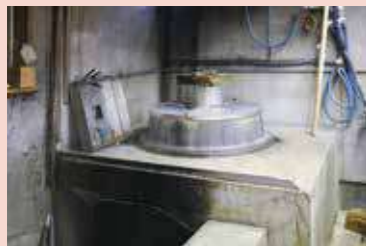
コウゾを煮る釜。液をアルカリ性にするため、かまどから出る灰を用いる
