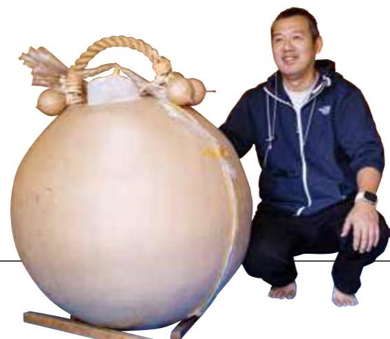
⇒三尺玉の持ち手に付いている小さな玉は時間差を出すために別付けに。上空で小玉が割れて開いた後に、一瞬遅れて三尺玉の花火が開く仕掛け
